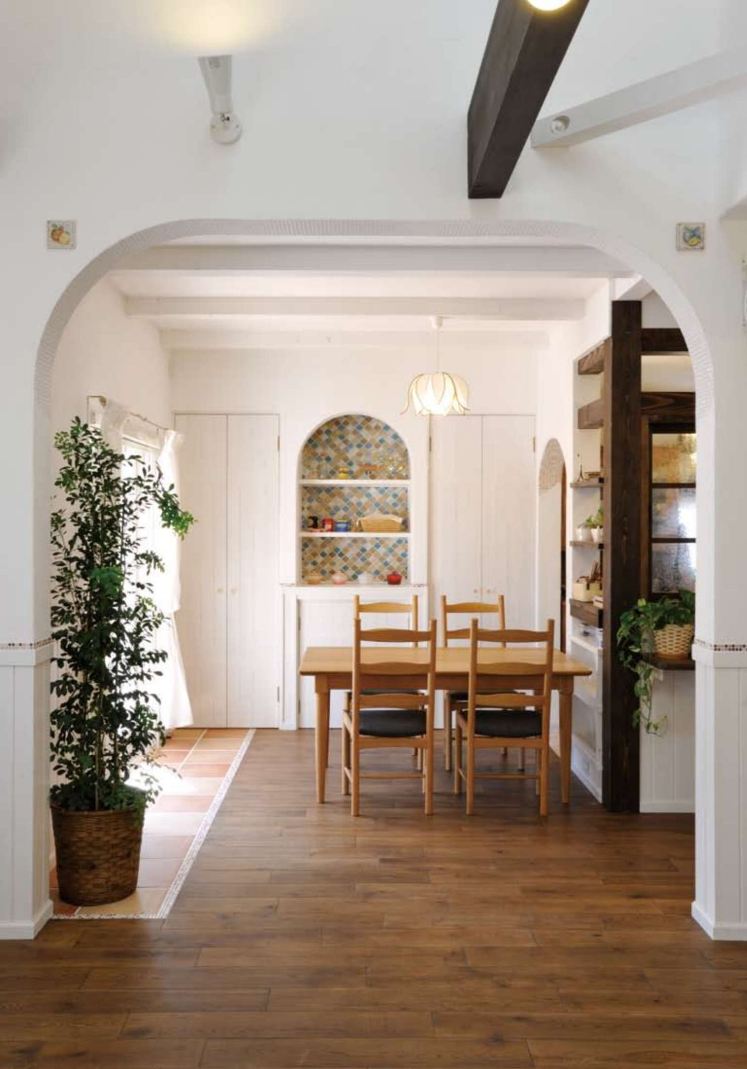
床はオーク無垢材の幅広タイプをブラウンで塗装し、アンティーク風の雰囲気を醸し出した。壁は塗りムラが味わいのある漆喰仕上げと板張りで仕上げられている。「タイルが大好きなので、いろんなところに使いたいとお願いました」というTさんの願い通り、床・壁・柱など様々なところにかわいらしいタイルが効果的に使用されている／見開き写真は全てT邸
