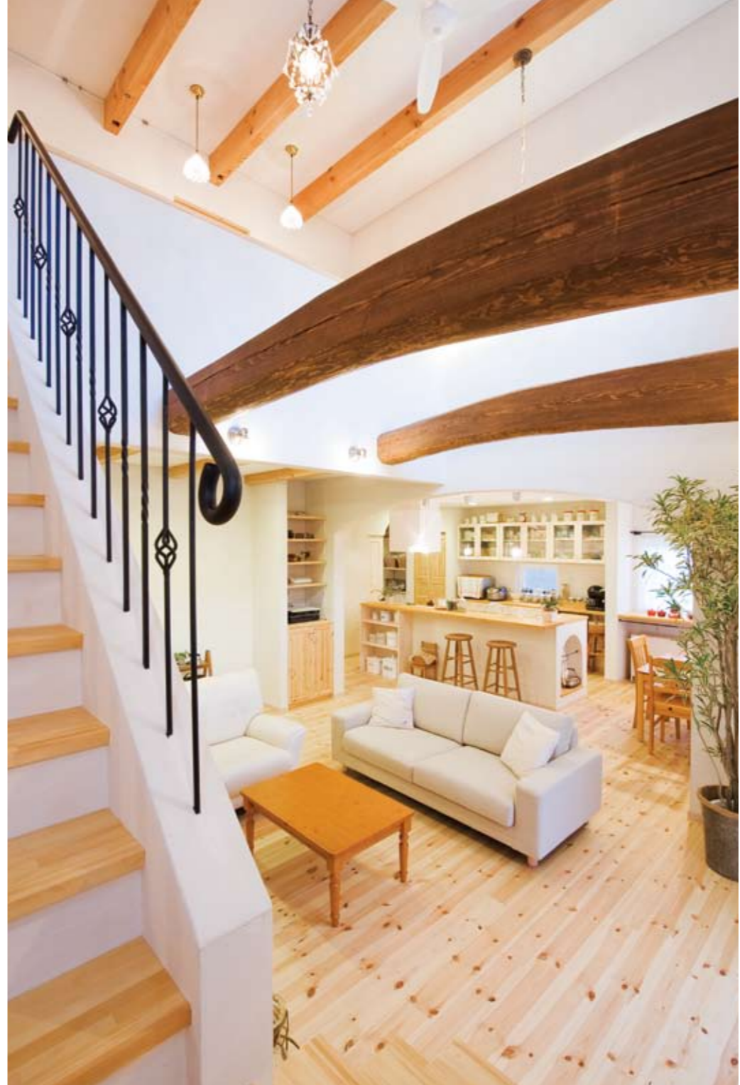
色やサイズについてもこだわったという古材風の梁が特徴的なY邸リビング。吹抜けで開放感があるがセルロースファイバー＋外断熱の「ダブル断熱」のおかげで蓄熱暖房1台で冬も快適。床はバイン無垢材、壁は塗り壁で仕上げられた空間にはYさんが大好きな雑貨もよく似合う
