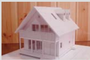
平面図では分かりにくい箇所も立体模型になるとイメージしやすくなる
